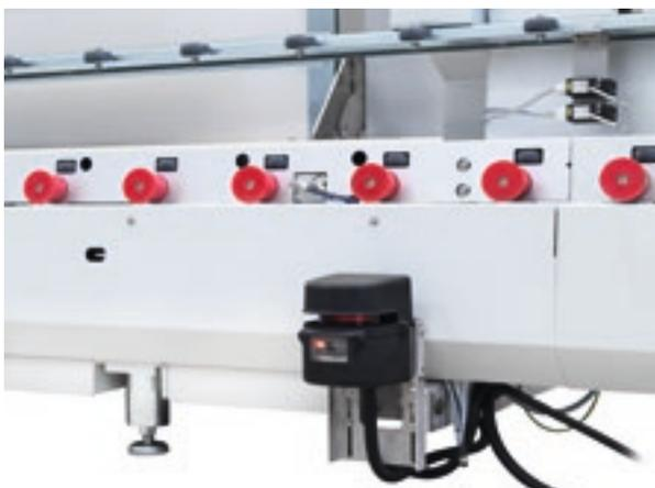
Scanner a laser na área de carga e descarga.
