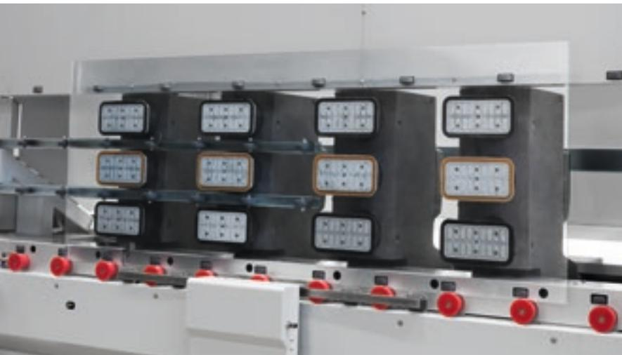
Sistema patenteado de 4 carros com 3 ventosas por carro, completamente independentes, que garantem a máxima flexibilidade, produção e a máxima qualidade, graças a um bloqueio do vácuo otimizado em toda a superfície a ser processada.
