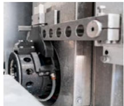
Retificador em stick para reafiação de rebolo diamantado e retificador de rebolo de polimento.
