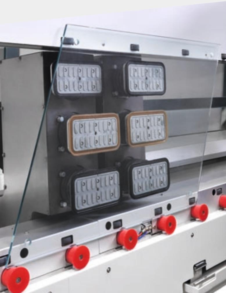
O sistema de reposicionamento dinâmico dos carros de ventosas (patenteado) foi concebido para processar uma peça sem nunca a deixar entre uma posição do carro de ventosas e o seguinte.
